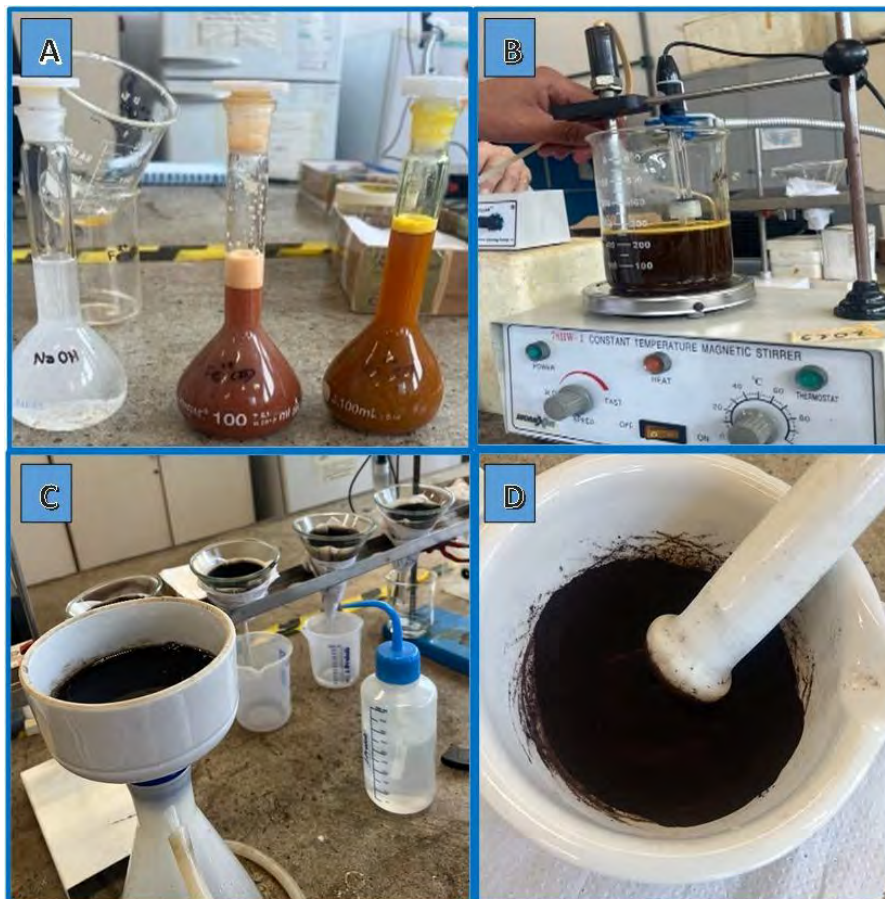
Figura 1. (A) Soluções de \text{Fe}^{+2} , \text{Fe}^{+3} e \text{NaOH} , (B) Formação de precipitado de magnetita, (C) Filtração do precipitado de magnetita. (D) Amostra de nanopartículas de magnetita funcionalizado ( \text{Fe}_3\text{O}_4\text{-AO} ).
