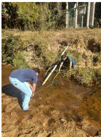
Figura 4 - Medição da seção de drenagem na fazenda São Francisco
