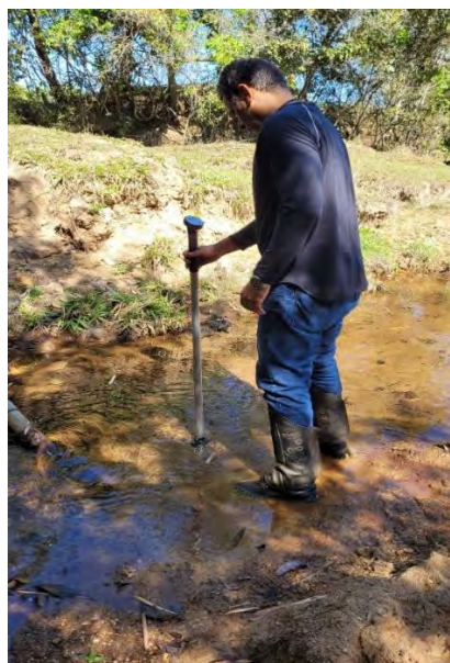
Figura 5 – Medição de velocidade da drenagem na Fazenda São Francisco
