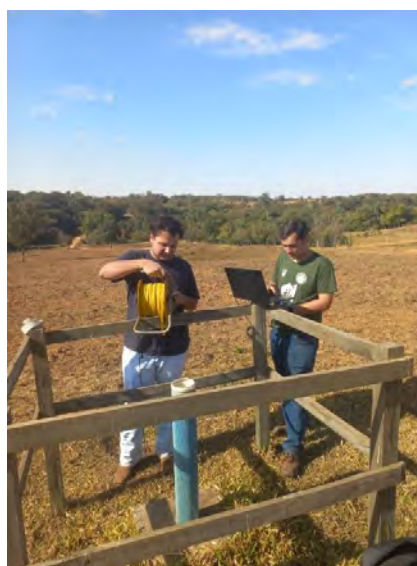
Figura 6 – Medição da profundidade de nível d'água em piezômetro na Fazenda São Francisco.
